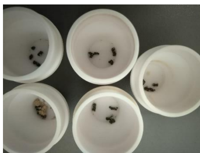
Rys. 2: Pozostałości po zakończeniu analizy TGA (popiół)
